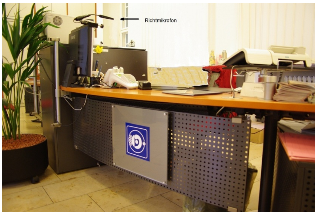
Abbildung 9 : Praktischer Aufbau eines lokalen Systems mit Richtmikrofon-Ansicht: Kunden-seite
